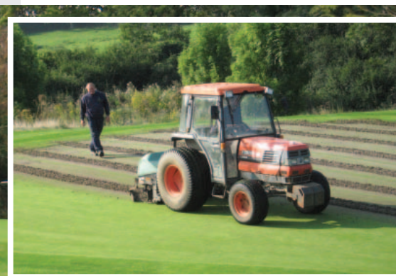
Aerifikácia greenu strojom JD Aercore s pracovnou hĺbkou 100 mm v augustovom termíne s cieľom zabezpečenia rýchlej regenerácie.
